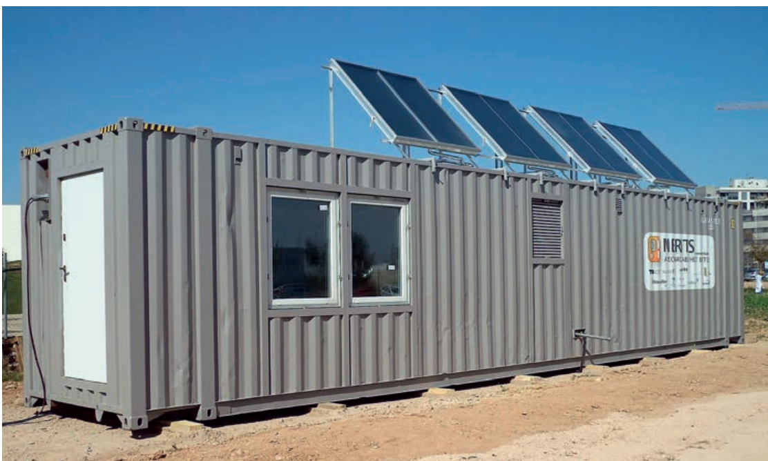
In het MERITS-project werken diverse Europese partners samen om de techniek voor warmteopslag te demonstreren. In deze mobiele testopstelling zijn acht modules met elk een capaciteit van ongeveer 35 kg ingebouwd. Met deze container zijn tests uitgevoerd in Spanje (zomer) en Polen (winter).
